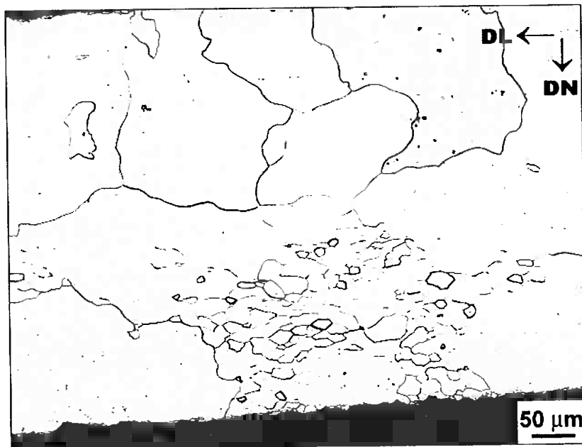
Figura 23 – Amostra BD010 (descarbonetada, 10% de deformação e recozimento em 700°C por 2 horas). Há um “cluster” não recristalizado.
