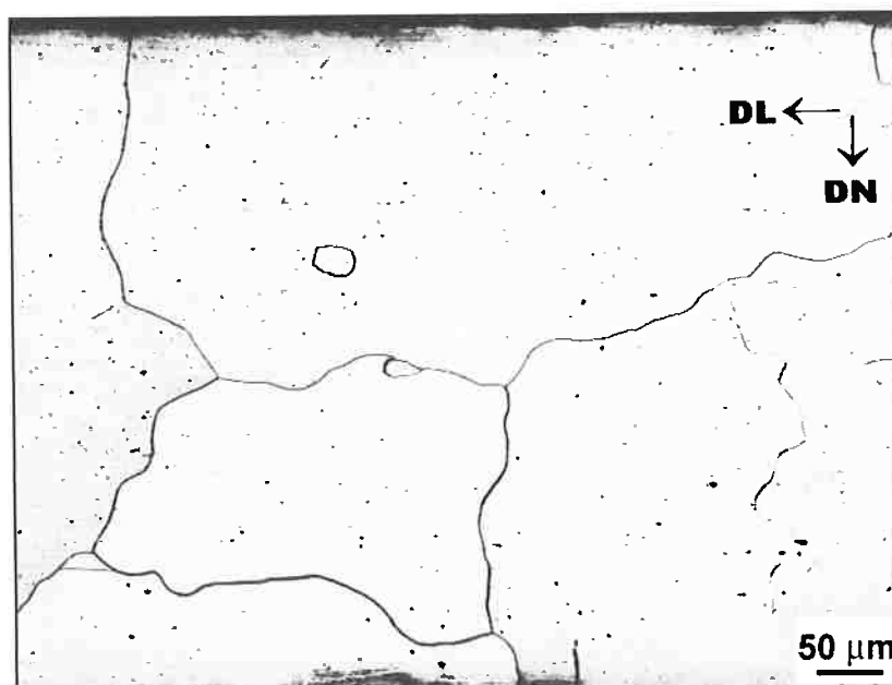
Figura 30 – Amostra ED006 (descarbonetada, 6% deformação e recozimento em 760°C por 2 horas).
